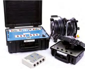
STCS plus может поставляться с наиболее подходящим комплектом кабелей в соответствии с габаритами трансформатора: напряжением до 150 или 500 кВ. Обе конфигурации поставляются с многоканальными кабелями стандартной (15 метров) или увеличенной длины (30 метров) для совместного использования с оборудованными передвижными электротехническими лабораториями.
